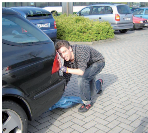
Recueil des gaz d'échappement
